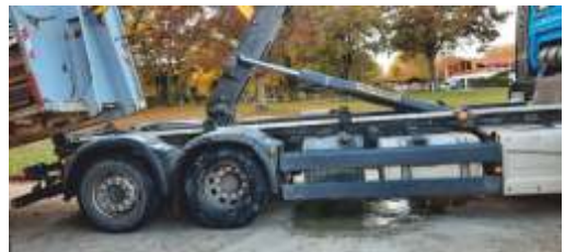
Beim Abladen platzt ein Hydraulikschlauch, also wieder warten
